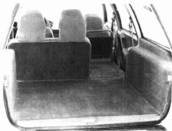
图 1-9 图示为 Citroen BX 车型宽阔的后行李箱, 1/3:2/3 的可折叠后座椅靠背。纵臂式后桥的副车架使得地板装配更加便利, 在轮罩处不需要另外的空间。较低的行李箱使得装载工作变得轻松。
