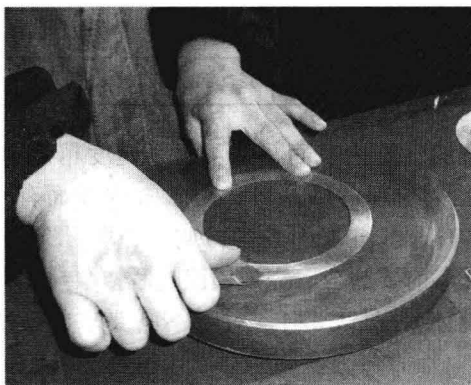
图 1-18 纯铜垫片研磨处理
