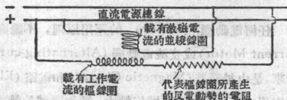
圖 1 直流電動機之線捲及其功用
