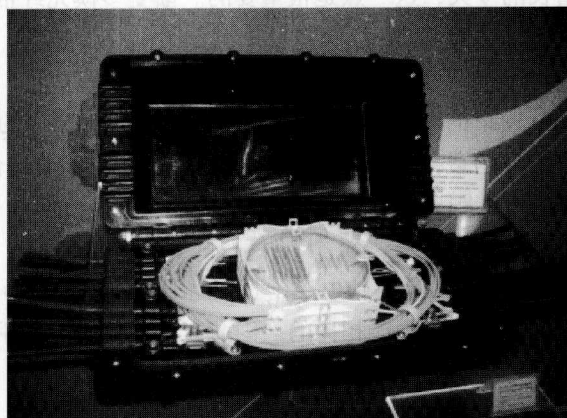
图 1-14 楼道和弱电竖井内使用的 24 芯光缆分纤盒
