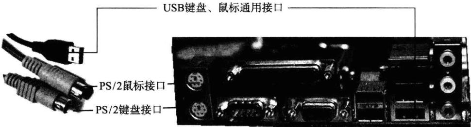
图 1-5 键盘、鼠标的接口及连接
