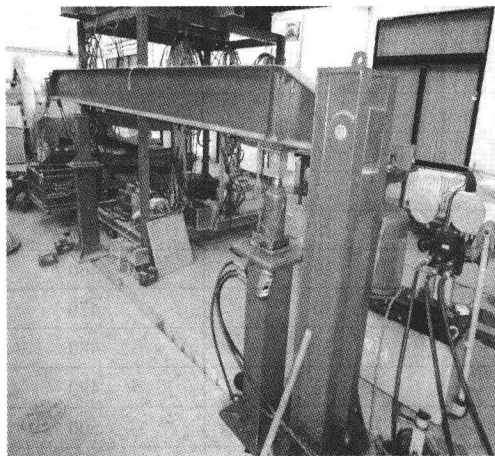
图 2-7 杠杆放大式稳压装置
