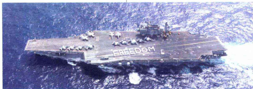
退役前一直以横须贺为母港的美国“小鹰号”核动力航母。可以看到其飞行甲板为斜角甲板。
