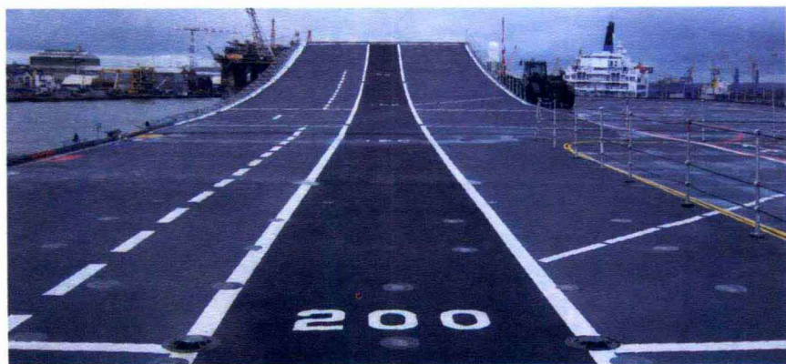
从后方拍摄的英国“皇家方舟”（Ⅲ）号航母。其滑跃甲板前方呈上坡形状。
