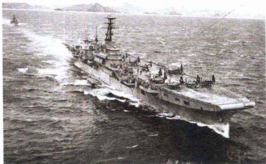
朝鲜战争时的英国巨人级“凯旋”号航母，图片中可以很清晰地看到与飞行甲板一体化的封闭式舰艏。
