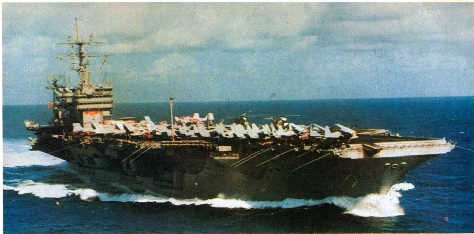
美国“艾森豪威尔”号航空母舰 该舰属“尼米兹”级，1977年10月开始服役。标准排水量81600吨，舰长332.9米，宽40.85米，吃水11.3米。舰员6054人。主要武器装备有：MK29八联装“海麻雀”对空导弹发射装置3座，MK15六管20毫米“火神密集阵”近程防御系统3座。舰载战斗机、反潜机、加油机、预警机和电子战飞机90-120架。
