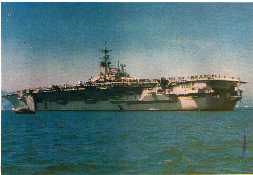
美国“艾森豪威尔”号航空母舰 该舰属“尼米兹”级，1977年10月开始服役。标准排水量81600吨，舰长332.9米，宽40.85米，吃水11.3米。舰员6054人。主要武器装备有：MK29八联装“海麻雀”对空导弹发射装置3座，MK15六管20毫米“火神密集阵”近程防御系统3座。舰载战斗机、反潜机、加油机、预警机和电子战飞机90-120架。
