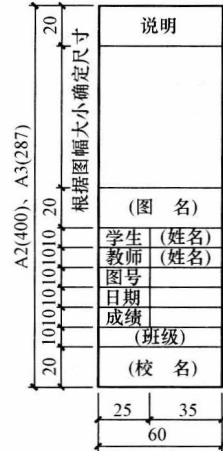
图 1-14 学生制图作业用标题栏推荐格式
