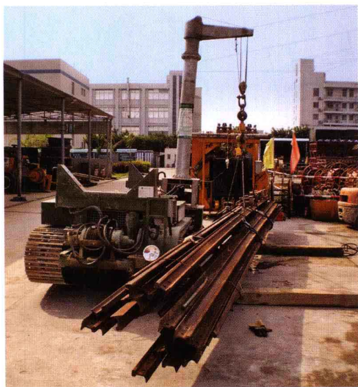
图 1-5-11 履带式运输车车载旋转吊臂卸车实例
