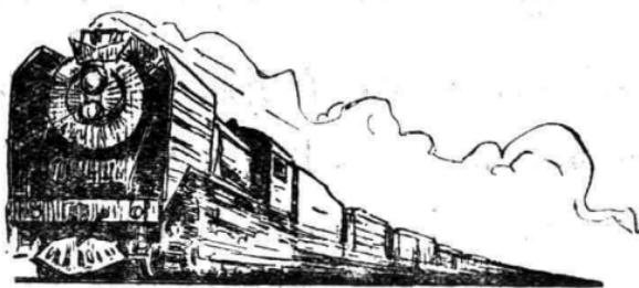
蒸汽机车的热效率还不到8%，就是它烧掉的煤里本有100分力量，却只能发挥出7—8分，把很多没有燃烧完的煤和很热的蒸气白白放跑了。它的力气比较小，最大的蒸汽机车不过两千多马力，但是，它的食量却很大，沿途要给它准备不少加煤加水的设备，跑不远就要停下来“喝”水“吃”煤。还由于它有很多笨重的机件的带累，很难跑得更快，所以现在许多国家，都在逐步淘汰蒸汽机车，用内燃机车和电力机车来代替它了。我国也在逐年增加内燃机车和电力机车，许多铁路线上的蒸汽机车已经越来越少。
