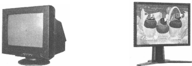
图 1—4 CRT 和 LCD 两种显示器
