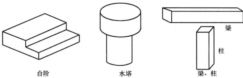
图 2-1 建筑构件的组成
