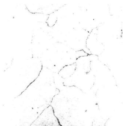
插圖二 純金屬（純鐵）的顯微鏡組織，灰色塊狀為晶粒，黑線為晶界（ \times 250 ）
