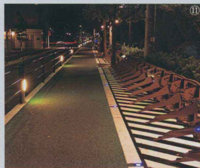
自行車停車場區配置 HID 70W 的雙燈式路燈，高度設定以不被樹木遮住燈光為準。
