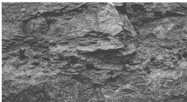
图 1.2-6 龙口坝基泥化夹层中岩屑的定向排列现象(贾国臣摄)
