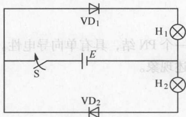
图 1.1.3 二极管单向导电性观察
