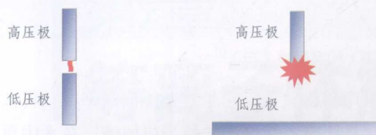
图2-4 脉冲电弧放电(左)和脉冲电晕放电(右)
