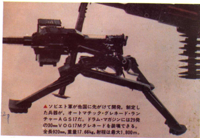
苏联AGS-17榴弹发射器 口径30毫米，全长920毫米，重17.6 射程1800米。
