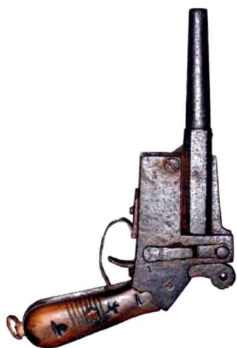
图16 抗日战争时期解放区兵工厂制造的半手工、半机械手枪。由于当时设备简陋，导致加工较粗糙，结构简单，使用时常会给使用者造成很大的风险。因其一次只能发射一颗子弹，俗称“单打一”，又因其装弹时需将枪管向下撇开，也称“两撇枪”。多数解放区军民正是用这样简陋的武器与侵略者作斗争，人民军队也正是在这样的艰险环境下一步步走向胜利，走向辉煌。此枪见证了中国人民在抗战时期的艰辛岁月，反映了抗战军民不屈不挠的反抗精神。
