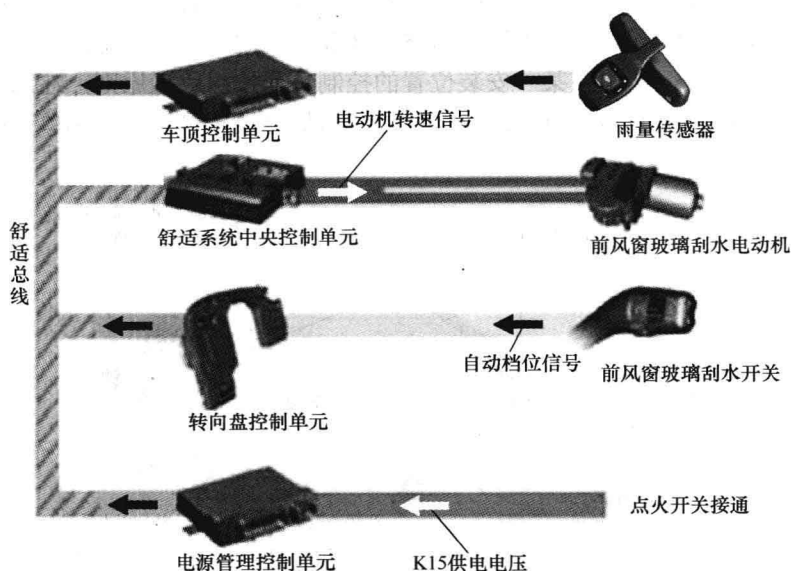
图 1-1 前风窗玻璃自动刮水功能
