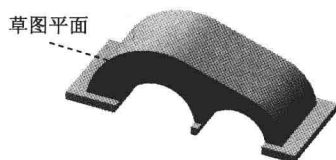
图 1.9 定义草图基准面
