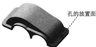
图 1.15 定义孔的放置面
