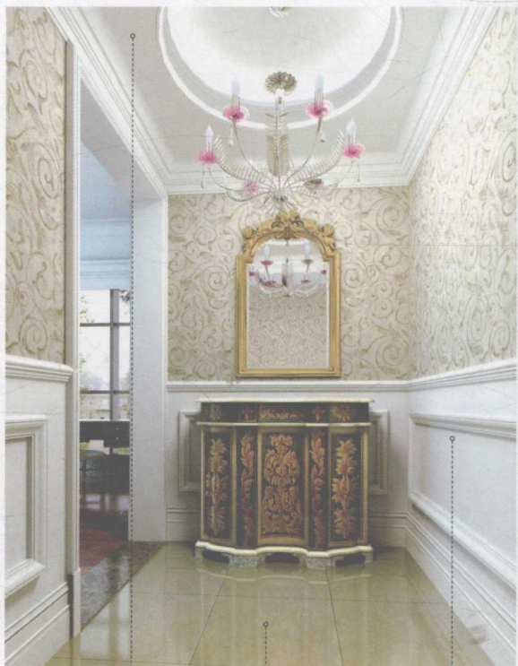
石膏板吊顶 釉面地砖 石膏板墙裙
