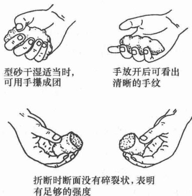
图 1-6 手感法检验型砂
