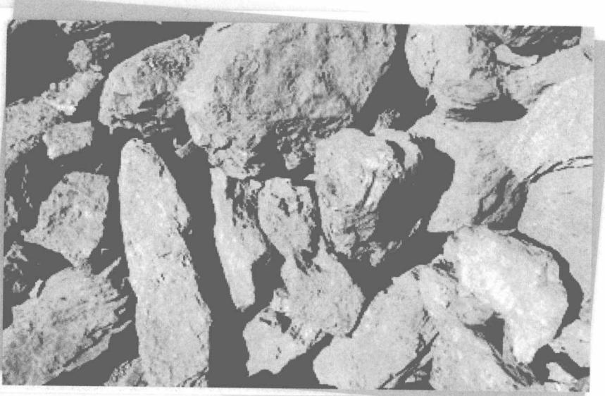
**高温干馏法**——把煤放在隔绝空气的密闭炼焦炉内，加高温（1000℃左右），就可以得到焦炭、煤气、煤焦油等主要产品。焦炭主要用于高炉炼铁、铸造和化肥工业；煤气既可作燃料，又是重要的化工原料；煤焦油是合成纤维、合成塑料、合成橡胶、染料和医药等行业的主要原料。
