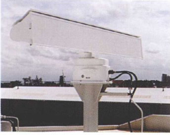
荷兰 Scout Mk2(S)调频连续波海岸监视雷达
