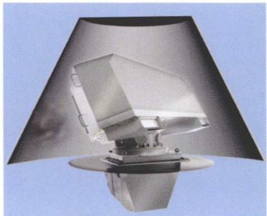
“海上长颈鹿”-AMB 雷达衍生于陆基型“长颈鹿”-AMB 雷达，装备了瑞典“维斯比”级隐形护卫舰和美国“独立”号濒海战斗舰
