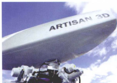
ARTISAN-3D (先进雷达目标指示态势感知及导航) 雷达设计用于提供三坐标对空警戒、水面火炮支援以及二次导航/水面监视等功能
