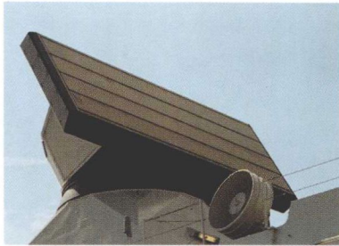
2005 年，S1850M 雷达装备了法国“地平线”级护卫舰和英国“伊丽莎白女王”级航母，后者将其命名为 Type 1046
