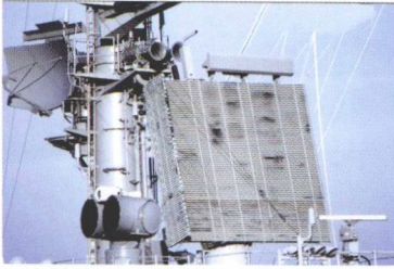
AN/SPS-48 是美国海军大量装备的三坐标远程对空搜索雷达，其外形和工作原理类似于 AN/SPS-52 雷达
