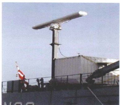
丹麦 SCANTER 导航、对海监视和船舶交通管制雷达
