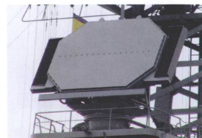
日本 OPS-24 舰载有源相控阵三坐标雷达，1990 年 1 月正式装备日本“朝雾”级导弹驱逐舰
