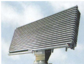
以色列 EL/M-2238 监视和威胁告警雷达 (STAR) 是一种全相干、脉冲多普勒、三坐标、多模式雷达系统
