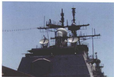
美国 AN/SPS-55 新型固态对海搜索和导航雷达
