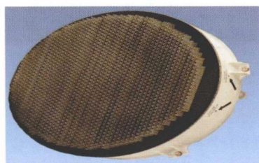
装备 F-35B/C 战机的 AN/APG-81 多模式有源相控阵雷达
