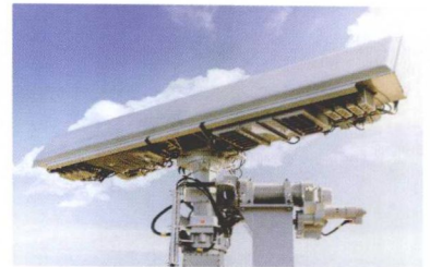
英国 AWS-9 三坐标监视雷达工作于 E/F 波段
