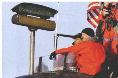
美国 AN/BPS-15 潜艇用轻型搜索和导航雷达
