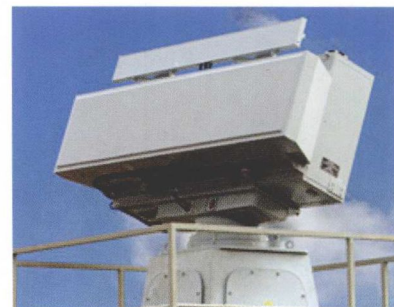
MRR-3D 雷达是一种多用途对海对空三坐标雷达，用来替换 DRBV-51 二坐标雷达和“海虎”雷达
