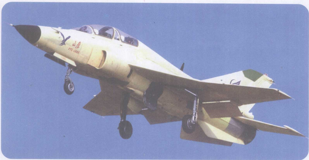
图1-1 正常形式布局的飞机——国产“山鹰”教练机
