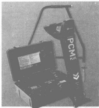
图 1.1-7 RD-PCM 电流测绘系统
