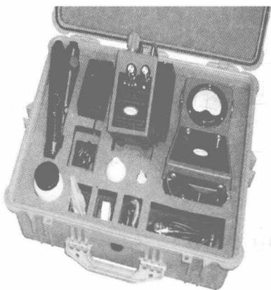
图 1.1-9 DCVG 直流电位梯度仪
