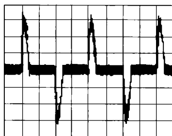
图 1-9 电容输入型电路的输入电流 (5A/DIV)
