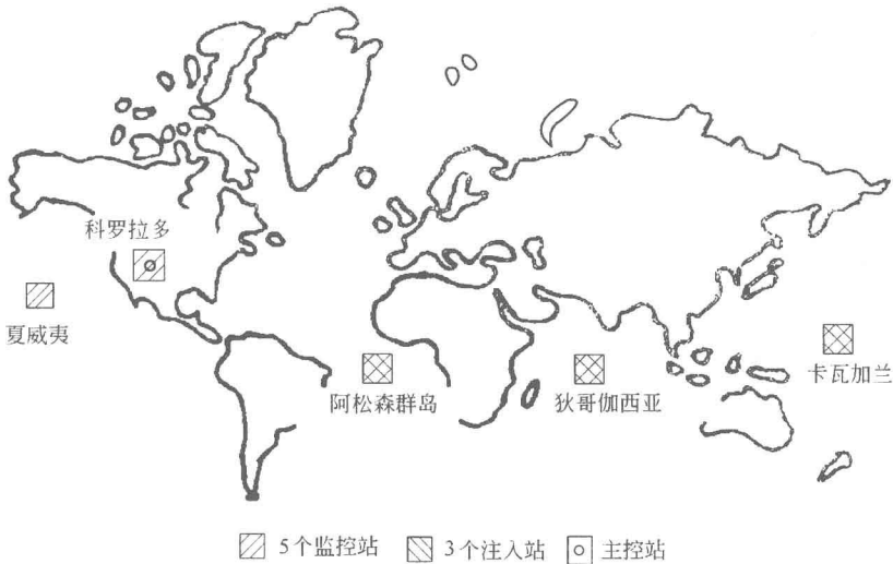
图 1-4 GPS 卫星的地面监控系统
