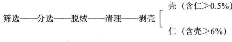
——软化  $\frac{10\sim12\%}{60^\circ\text{C 左右}}$  轧胚  $\frac{0.3\sim0.4\text{mm}}{\text{蒸炒 (1.5\sim2.5\% 水) 125\sim128}^\circ\text{C}}$
