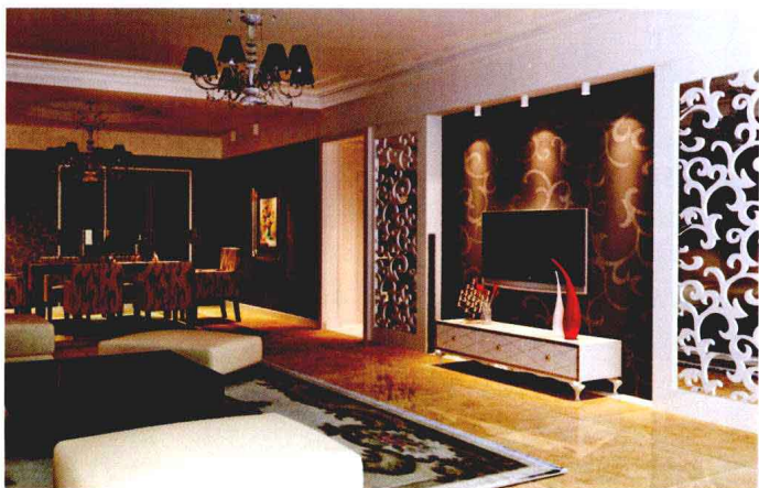
壁纸+白色混油 +水银镜，里层贴壁 纸，用大芯板造型， 白色混油饰面，内嵌 水银镜，造价约290 元/平方米。
