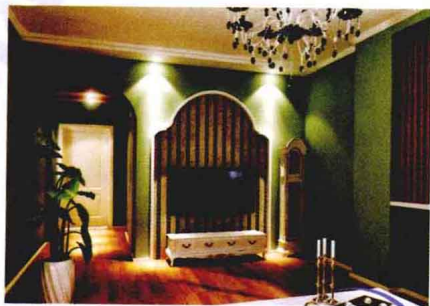
壁纸+石膏板，以木龙骨做框架，石膏板做造型，乳胶漆饰面，里层贴壁纸，造价约160元/平方米。
