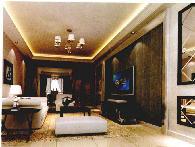
壁纸+石膏板，以木龙骨做框架，石膏板做造型，乳胶漆饰面，里层贴壁纸，造价约160元/平方米。
