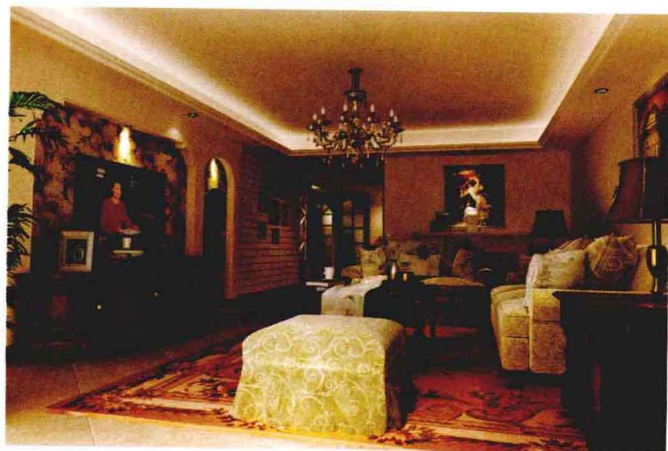
壁纸+石膏板，木龙骨做框架，石膏板造型，面层喷涂乳胶漆，里层贴壁纸，造价约210元/平方米。
