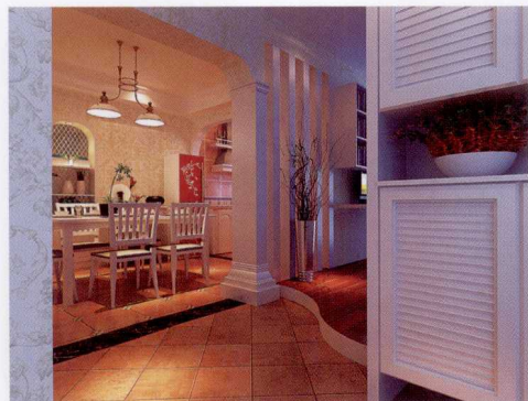
垭口 [ 石膏罗马柱 ] 地面 [ 仿古砖斜铺 ]
