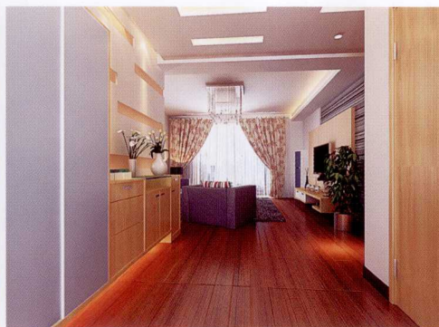
左侧墙 [ 鞋柜 + 石膏板造型 + 彩色乳胶漆 ]
