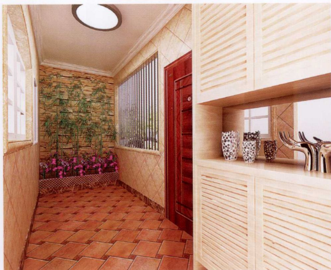
顶面 [石膏顶角线] 地面 [仿古砖斜铺]
