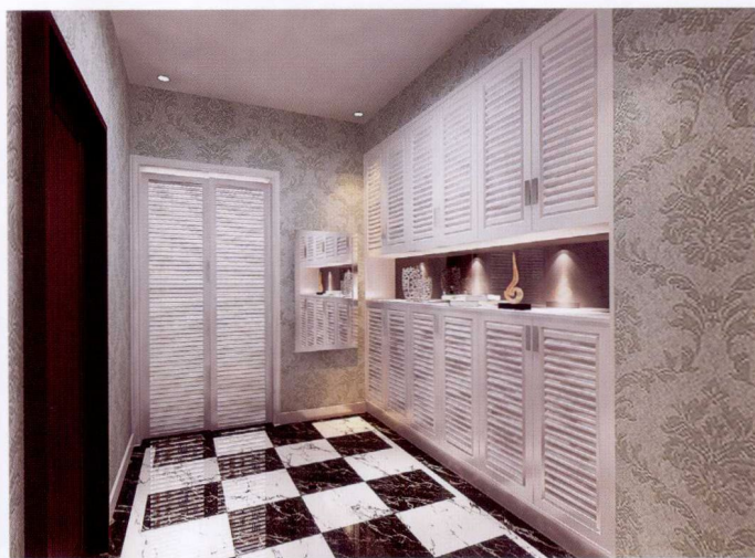
右侧墙 [入墙式鞋柜 + 灰镜 + 墙纸] 地面 [双色地砖相间铺贴]
