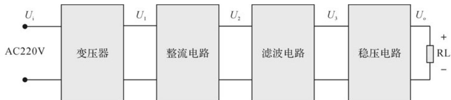
图 1-1 直流稳压电源基本组成框图
