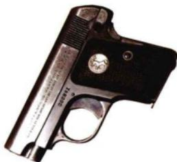
袖珍型手枪的设计面临很多难题，其中最大的难题就是如何实现外形尺寸与枪械性能之间的平衡，因为袖珍型手枪注重隐蔽性和便携性，外形要尽可能紧凑，尺寸要尽可能小，这也带来了一系列问题。首先，结构精细而密集的袖珍型手枪可能非常“娇贵”，需要经常保养，否则很有可能在突发的战斗中难以操作。其次，尽管袖珍型手枪发射的子弹也足以致命，但袖珍型手枪的容弹量都很低，一般为6发或7发。再次，多数袖珍型手枪的准星都很小，甚至是没有准星，再加上偏短的枪管，这对射击精度有很大的影响。
