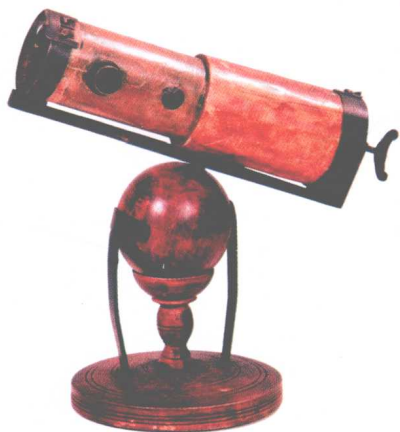
▲ 牛顿发明的反射望远镜，它不像折射望远镜那样笨重，而且避免了色差。
