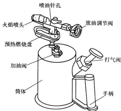
图 1-5 喷灯的结构示意图
