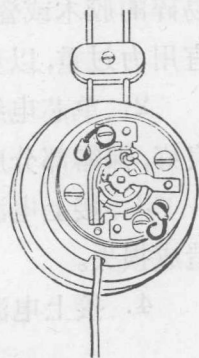
图 1-1-8 螺丝压接式接线桩头的接线法
