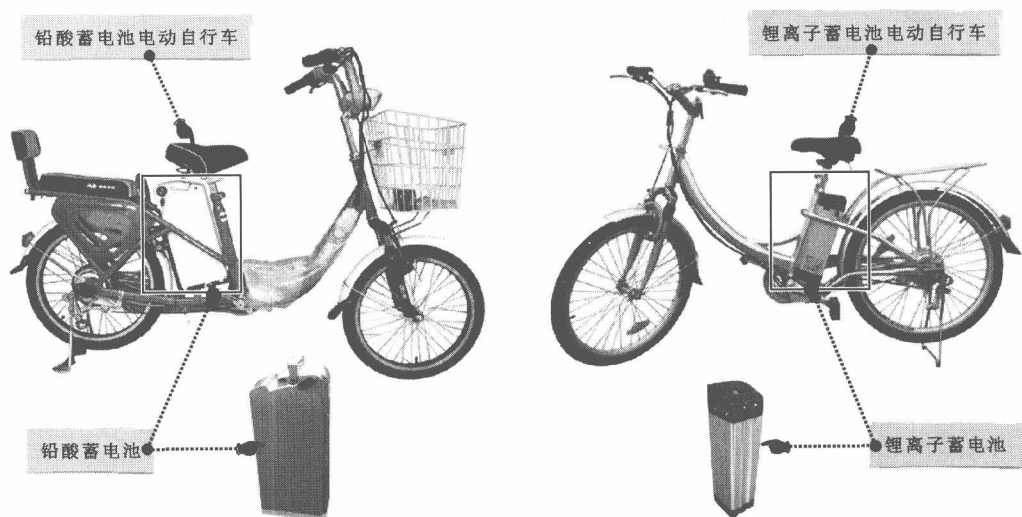
图1-4 不同动力源类型的电动自行车
