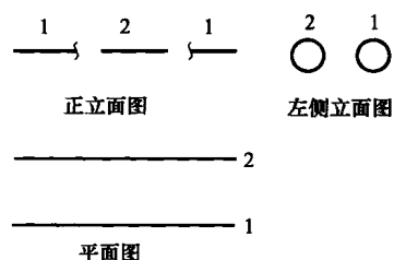
图 1-29 两条直管在正立面图上的重叠
