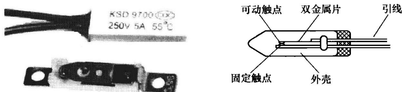
图 1-8 平直形双金属片式温控器的实物与结构图
