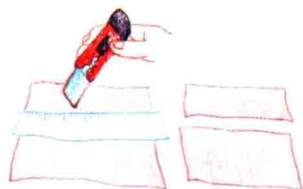
把尺子放在纸张上面，用手固定住，再用美工刀沿着尺子的边缘划下，就可以裁出整齐的纸张了。
