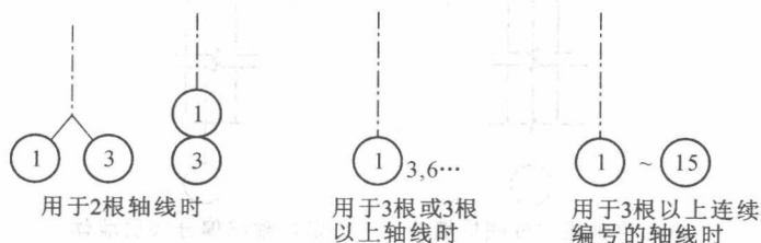
图 1.5 详图的轴线编号
