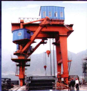
西部大开发十大主要工程之一四川岷江紫坪铺水利枢纽工程2000kN坝顶门机
