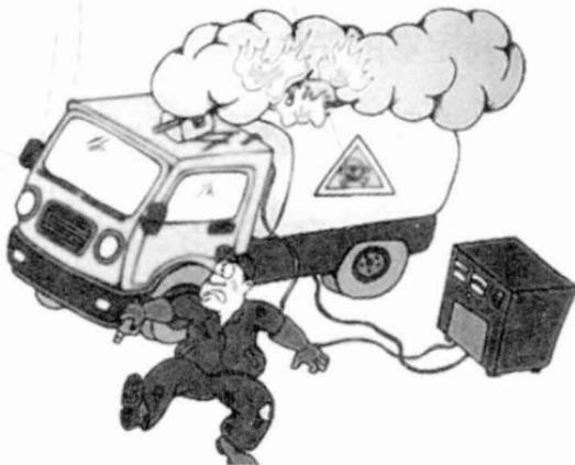
6. 与动火点相连的管线应进行可靠的隔离、封堵或拆除处理。动火前应首先切断物料来源并加盲板或断开，经彻底吹扫、清洗、置换并经检测合格后，方可作业。
