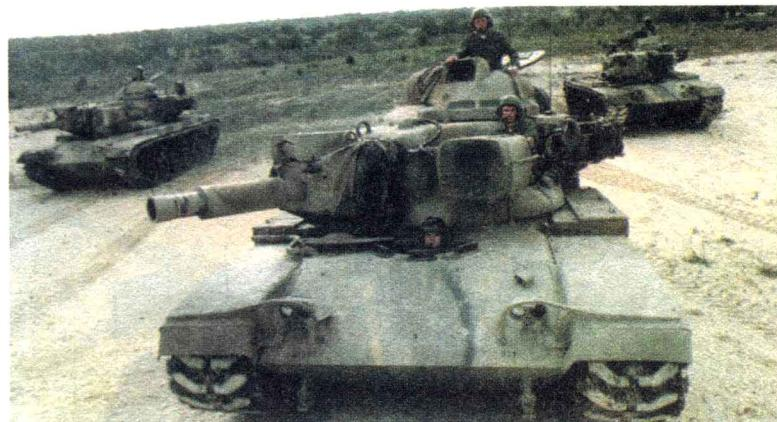
左图：M60A2坦克成为主产的变型车，但由于其复杂的火炮/导弹装备，被装备了更为常规的105毫米火炮的M60A3所取代。
