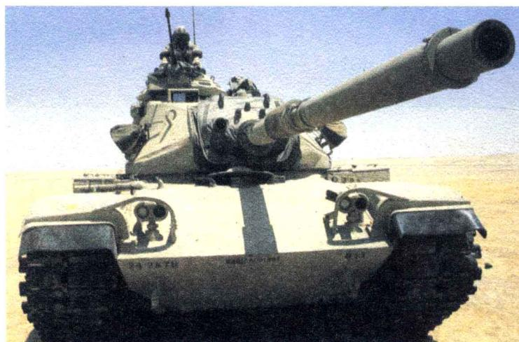
左图：M60坦克的装甲厚度是T-62的两倍多。正如以色列人在1982年黎巴嫩所展示的那样，105毫米的火炮完全能够击毁早期型号的T-72坦克，但它还需要改进型弹药以对付装甲更厚的T-64坦克。
