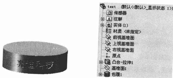
图 1.1 零件模型及设计树
