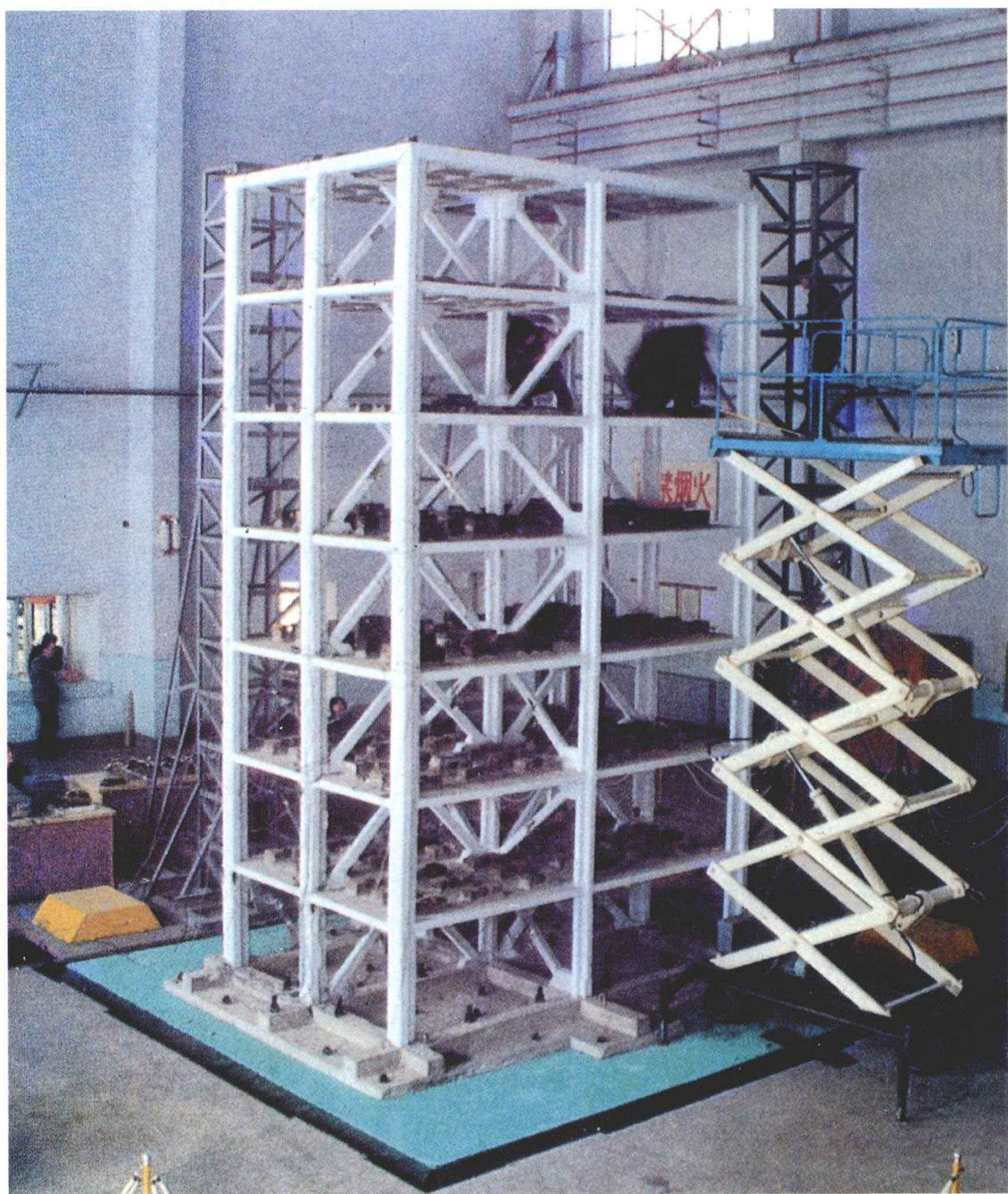
[67] 国家地震局工程力学研究所与另一单位协作研制的“5米×5米双水平向地震模拟振动台”达到国际同类振动台 80 年代先进水平
