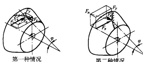
图 5.1-2 弧齿锥齿轮传动的作用力示意图
