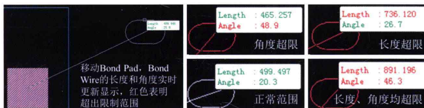
图 11-18 添加 Bond Wire 和移动 Bond Pad 时能实时显示跨距和角度信息
